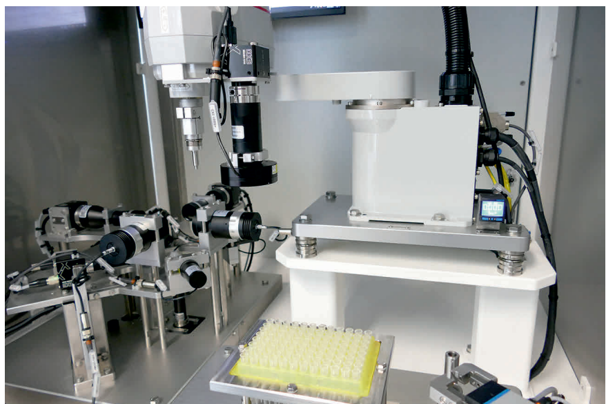
Die Pipettenspitzen (unten) werden automatisiert in den Bereich des Kamerasystems gebracht. © Ziemann & Urban
