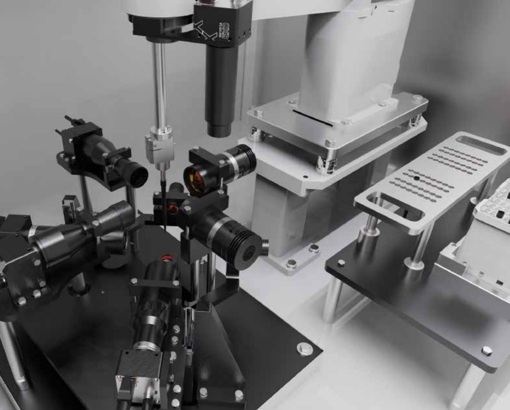
Vier Kameras mit je 8,1 Megapixel in Kombination mit telezentrischen Objektiven inspizieren die Pipettenspitzen.
